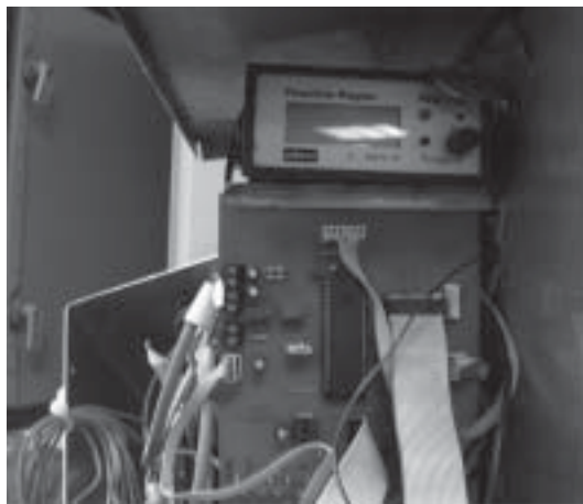
Figura 10. Montaje de la tarjeta electrónica en el deshidratador
