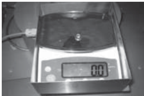
Figura 5. Balanza modificada con comunicación serial para medir el peso en línea.
