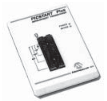
Figura 6. PIC START PLUS (Grabador de microcontroladores PICS de MICROCHIPS)
