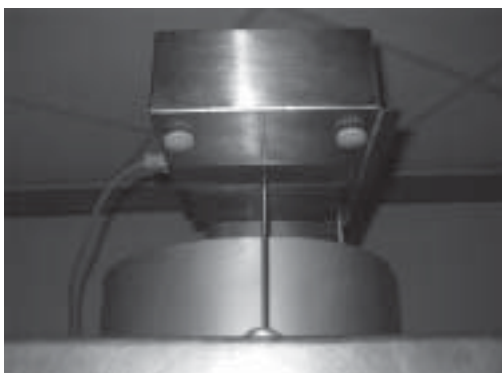
Figura 14. Instalación de la balanza modificada en el deshidratador.
