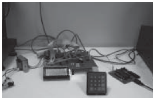
Figura 8. Simulación de intercambio de comunicación entre la balanza modificada y el deshidratador, en tiempo real.
