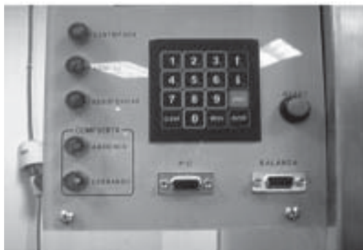
Figura 11. Montaje de la tarjeta electrónica en el deshidratador.
